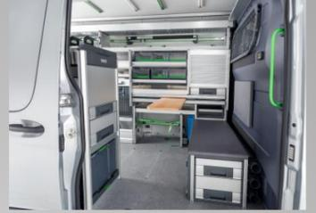
Unser perfo Lochwandsystem ermöglicht das Anbringen von Haken und Haltern für Ihr Werkzeug überall im Fahrzeug. Hier ist sämtliches Material schnell griffbereit und übersichtlich angeordnet.
