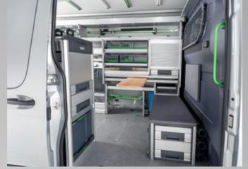
Unsere Fahrzeugeinrichtung ist universell konfigurierbar und bietet eine große Vielfalt an Möglichkeiten für die Ladungssicherung. Besonders praktisch ist unser neues C-Lash System, mit dem Sie einfach und schnell Zurrgurte an Regalen und Ablagewannen integrieren können. Auch die Schubladen im Kfz-Regalsystem bieten viel gut strukturierten Stauraum. Eine Klappwerkbank mit integriertem Schraubstock erweitert den Arbeitsbereich am Heck des Fahrzeugs.
