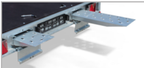
• RAMPENSCHÄCHTE UNTER DER BODENPLATTE
