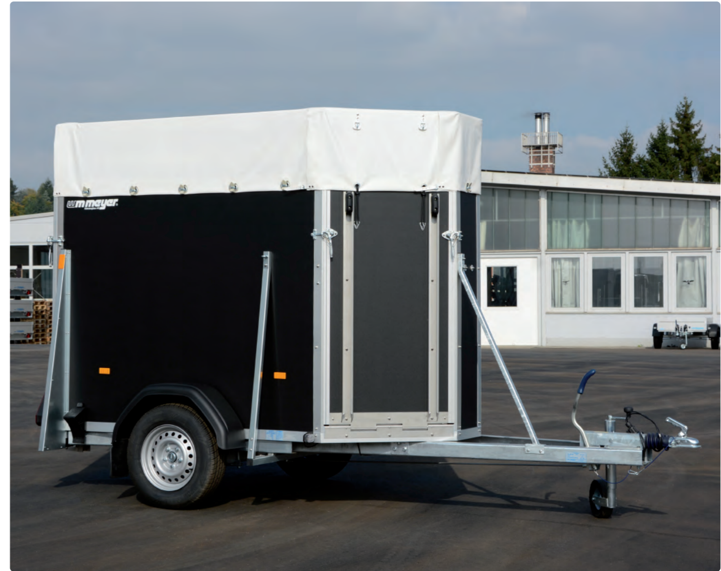
V 1325/129 Achse, Rahmen und V-Deichsel verzinkt, Zubehör: Frontausstieg, Hochplane und Aluspriegel (Höhe: 350 mm) V 1325/129 Essieu, châssis et timon en V galvanisés, options : pont avant, bâche haute et ossature en alu (hauteur : 350 mm) V 1325/129 Galvanised axle, chassis and V drawbar, optional extras: front exit, high canvas top and aluminium support (height: 350 mm)
