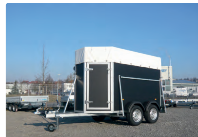
V 2730/149 Zubehör: Hochplane und Aluspriegel V 2730/149 Options : bâche haute et ossature en alu V 2730/149 Optional extras: high canvas top, aluminium support
