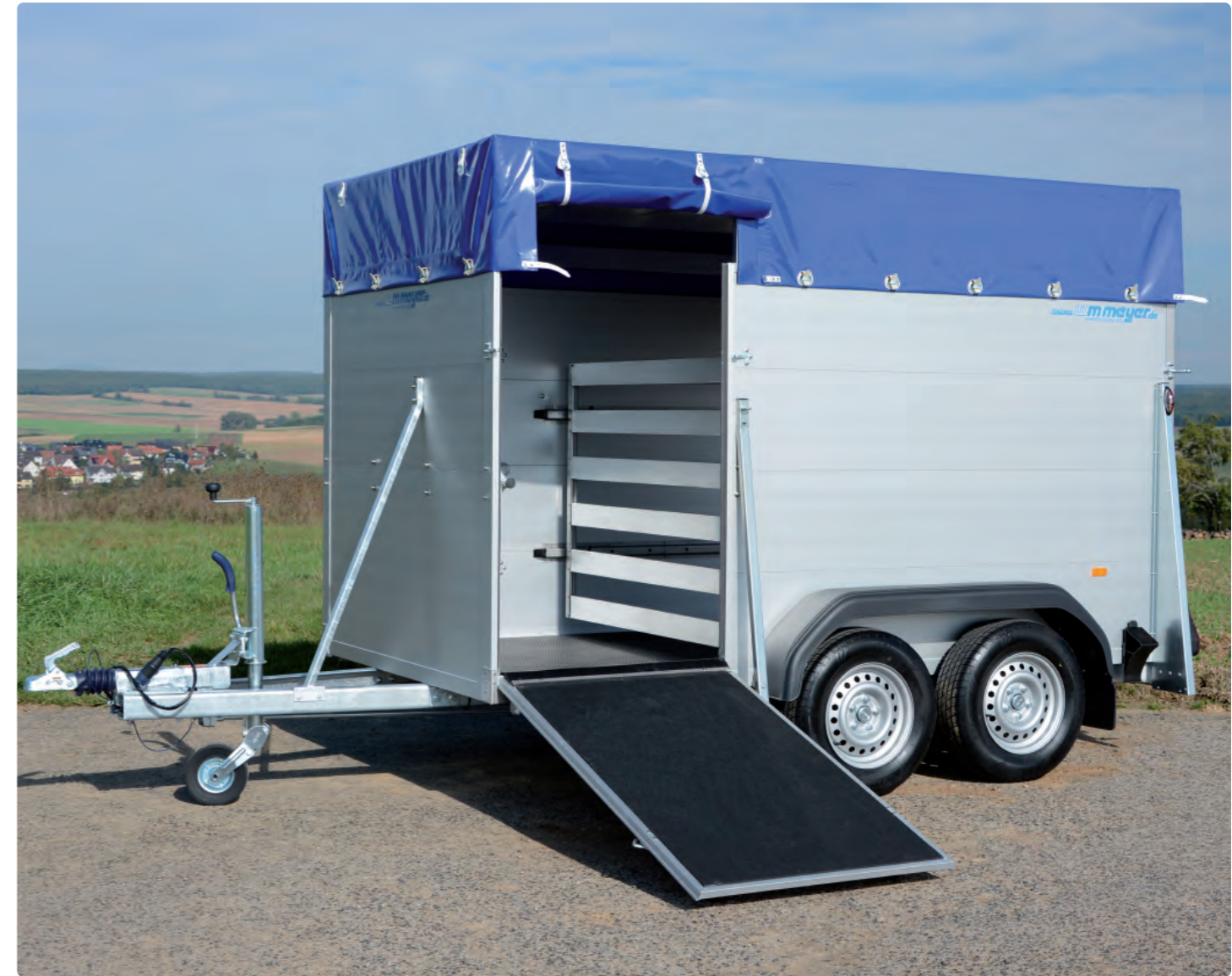
V 2730/164 Vollaluminiumanhänger, Zubehör : Gummiboden, Frontausstieg, Trenngitter, Hochplane und Aluspriegel V 2730/164 Bétaillère complètement en alu, options : protection plancher, pont avant, séparation à l'intérieur, bâche haute et ossature en alu V 2730/164 All-aluminium trailer, optional extras: rubber floor covering, front exit, cross division, high canvas top and aluminium support
