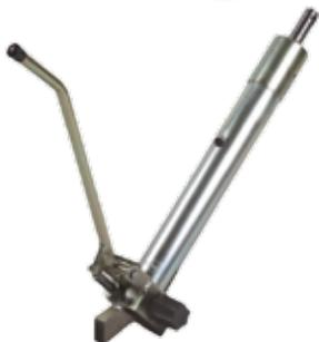
**Hydraulischer Pumpenzylinder Typ VHL 2024**, für den Einbau in Auto-Transport-Anhänger, Sicherheitsauslöser mit Überdruckventil, wartungsfreies, geschlossenes Hydrauliksystem, Einbaulänge 677 mm, Hub 440 mm, Tragfähigkeit 2000 kg
