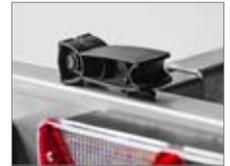
Schnellverschluss an der ausziehbaren Lichtleiste zur Arretierung
