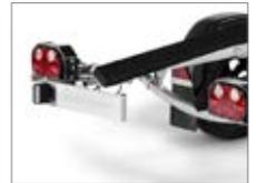
Abklappbare, wasserdichte Einzelbeleuchtung
