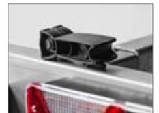
Schnellverschluss an der ausziehbaren Lichtleiste zur Arretierung
