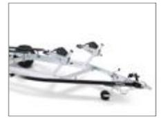
V-förmige Deichsel für eine bessere Stabilität und ein sicheres Fahrverhalten
