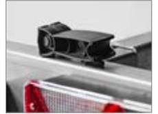
Schnellverschluss an der ausziehbaren Lichtleiste zur Arretierung
