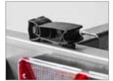
Schnellverschluss an der ausziehbaren Lichtleiste zur Arretierung
