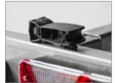
Schnellverschluss an der ausziehbaren Lichtleiste zur Arretierung
