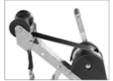
Winde mit Schutzabdeckung, Seilwindenstand individuell einstellbar
