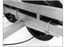
Verstellbare Achsen. Die Achsen können individuell eingestellt werden, um eine optimale Gewichtsverteilung und Stützlast zu erzielen.
