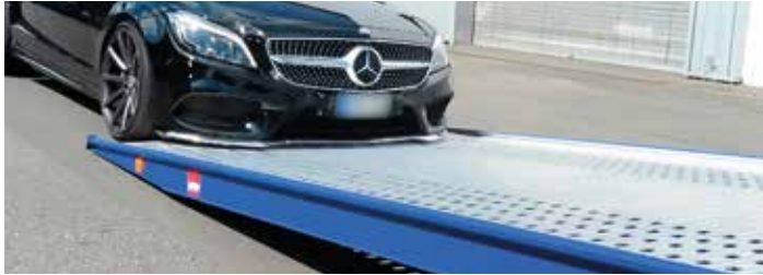
ATC 3522 V / VL. Verschiebeweg der Plattform: 2500 mm.
