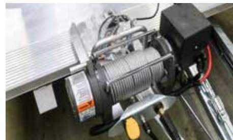
Optional mit Elektro-Seilwinde und unterschiedlichen Stromversorgungsmöglichkeiten.
