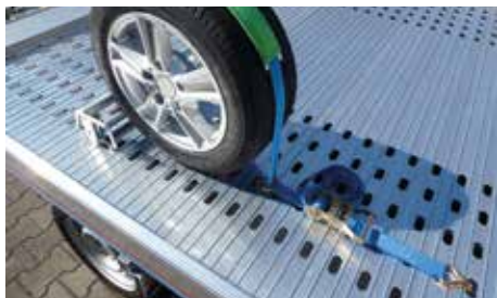
Verzurren bei der Lochblechplattform.
