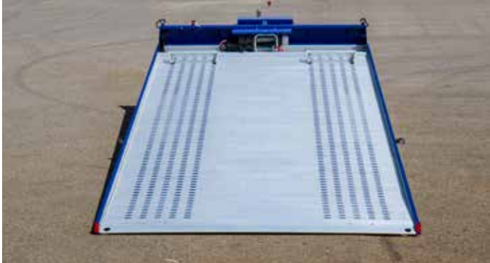
Lochblech: Die Plattform des ATC - VL.
