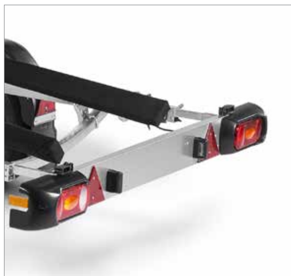
Einfachste Bedienung des Leuchtenträgers Der Leuchtenträger ist serienmäßig mit Schnappverschlüssen versehen. Dies erleichtert den schnellen An- und Abbau.
