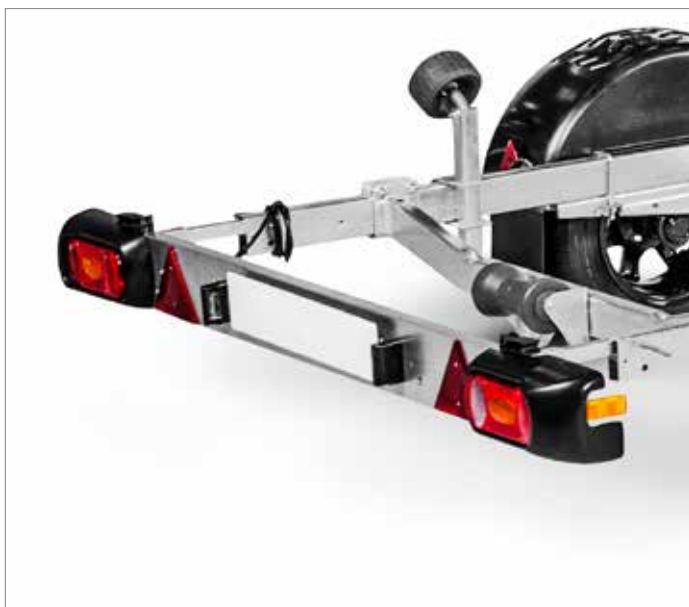
Abnehmbarer und teleskopierbarer Beleuchtungsträger.
