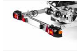
Der Leuchenträger ist serienmäßig mit Schnappverschlüssen versehen.
