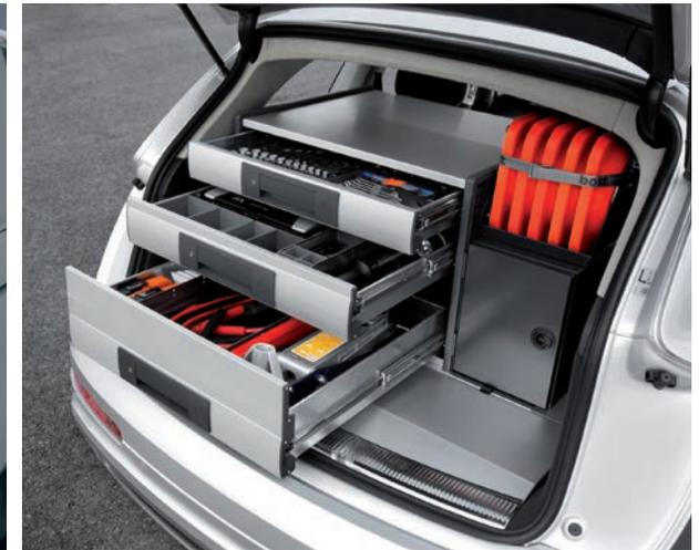
So vielseitig die Tätigkeiten einzelner Branchen sind, so unterschiedlich ist auch deren Anspruch an eine Fahrzeuginrichtung. Jedes Berufsfeld hat sein eigenes Ladegut, sein typisches Werkzeug und ein spezielles Zugriffsraster.
